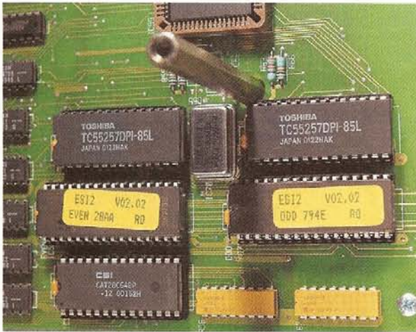
De EPROMs met de software voor de Nedap-stemmachines zijn op het moederbord eenvoudig aangebracht in sockets en kunnen makkelijk worden vervangen.
