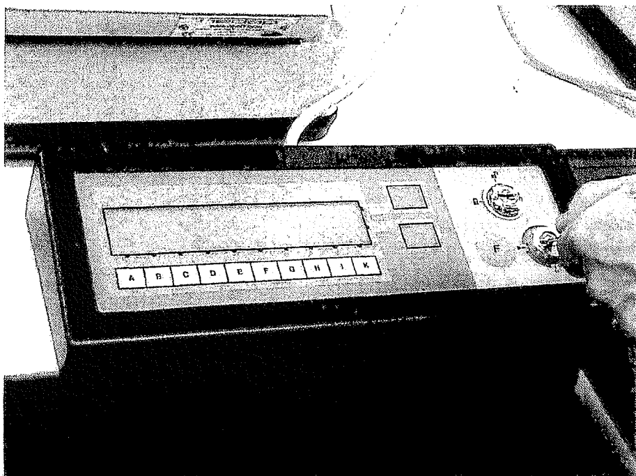
Figuur 4 - Bedieningspaneel van de Duitse stemmachine ESD-1
