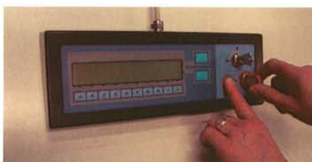
Functietoest "F" indrukken en gelijktijdig bedieningsleutel (rood) in horizontale stand draaien
